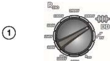
Установите поворотный переключатель выбора функций в положение **DD**. Прибор находится в режиме измерения напряжения
