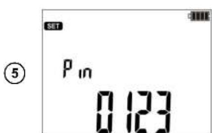
PIN-код, устанавливаемая цифра мигает. Переход к следующей цифре клавишами **F3** и **F4**.
