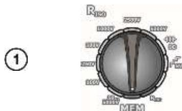
Установите поворотный переключатель выбора функций в положение **MEM** и нажмите на клавишу **MENU**.
