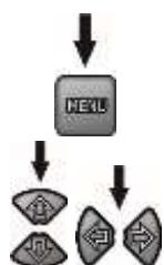
Нажимая клавишу  **MENU** можно перейти к выбору времени для расчёта коэффициентов абсорбции ( $t_1$ ,  $t_2$ ,  $t_3$ ) и общему времени измерения  $t_n$ , тока  $I_{SC}$  и  $limit$  (только **MIC-5010**).
