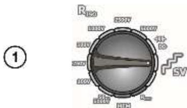
Установите поворотный переключатель выбора функций в положение **SV**. Прибор находится в режиме измерения напряжения.
