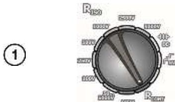
Установите поворотный переключатель выбора функций в положение  $R_{CONT}$ .
