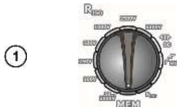
Установите поворотный переключатель выбора функций в положение **MEM**.
