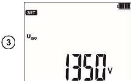
Измерительное напряжение **U<sub>Iso</sub>**.
