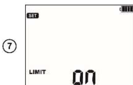
⑦ Включение (**ON**) и выключение (**OFF**) установки пределов измерения (только **MIC-5010**).
