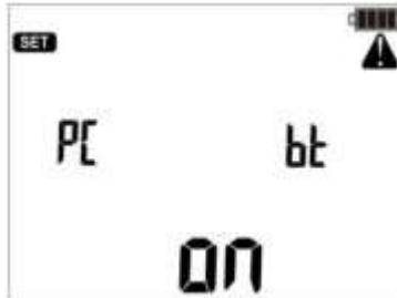
При появлении экрана меню конфигурации с помощью клавиш **←** и **→** перейдите к экрану **bt**.
