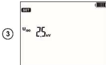
Максимальное (окончательное) измерительное напряжение:
