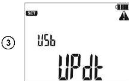
Подключите измеритель к ПК с помощью USB кабеля и нажмите клавишу **ENTER**.
