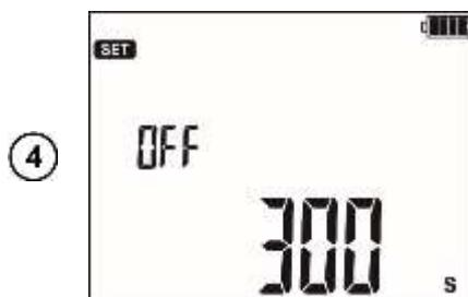
④ Время до автоматического выключения (300 сек., 600 сек., 900 сек.) или его отсутствие (----).
