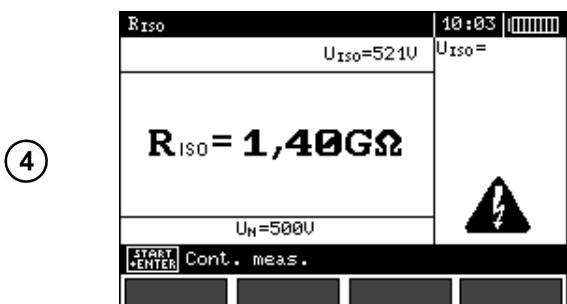
Отображаемая на экране информация при измерении
