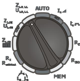
Установите поворотный переключатель в режим  $Z_{L-N,L-L}/U_{L-N,L-L}$ .
