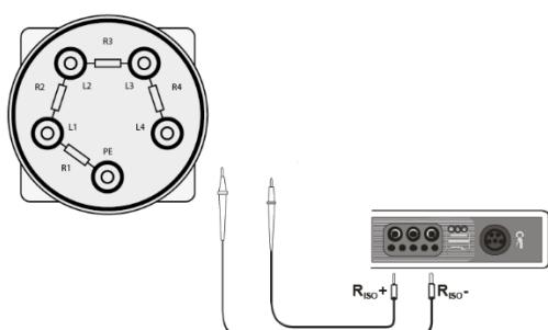
Подключите измеритель согласно схеме.
