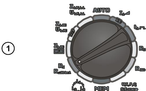
Установите поворотный переключатель в режим  $R_x$ ;  $R_{\pm 200\text{mA}}$ .
