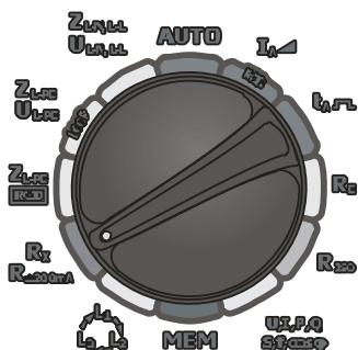
Установите поворотный переключатель в режим  $R_x$ ;  $R_{\pm 200mA}$ .
