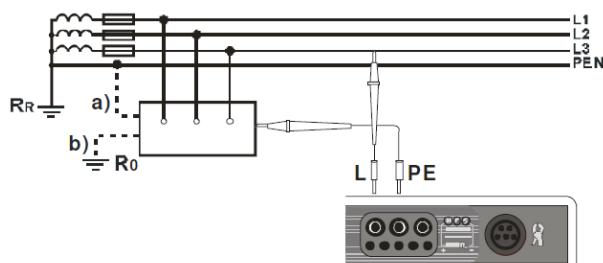
Схемы подключения для разных типов сетей:
