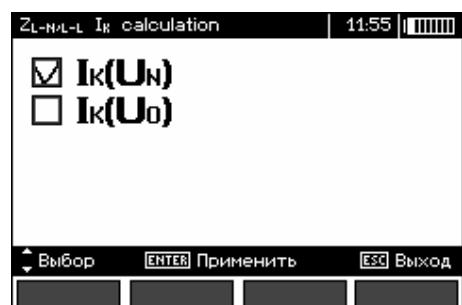
Нажмите клавишу **F2** для выбора опорного напряжения для расчёта тока КЗ.
