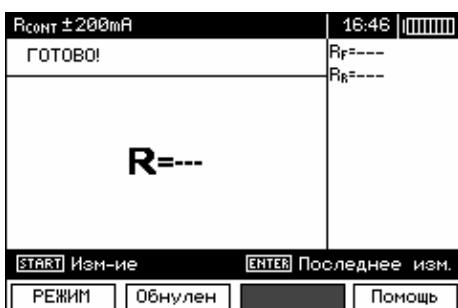
Для отмены **AUTOZERO** компенсации сопротивления (возврат к базовой калибровке), повторите описанный выше процесс, но в пункте 3 разомкните измерительные провода.
