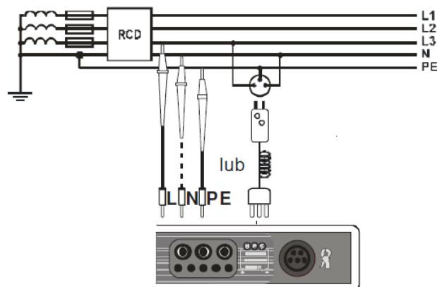
Подключите измеритель согласно схеме.
