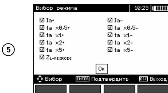
Нажмите **F2 РЕЖИМ** для установки измеряемых параметров.
