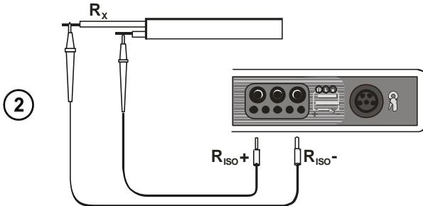
Подключите измеритель согласно схеме.
