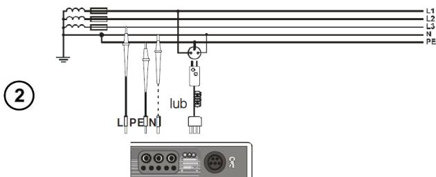
Подключите измеритель согласно схеме:
