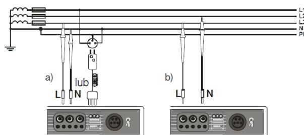
Подключите измеритель согласно схеме на следующем рисунке:
