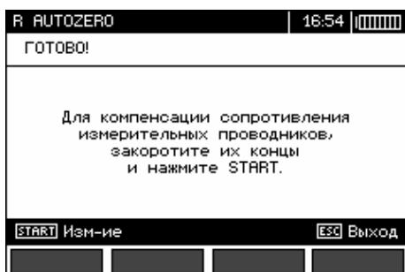
Следуйте инструкциям, отображаемым на дисплее.
