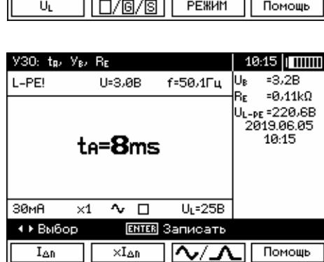
Все замечания и сообщения идентичны режиму измерения тока срабатывания устройств защитного отключения (УЗО) I<sub>A</sub>.
