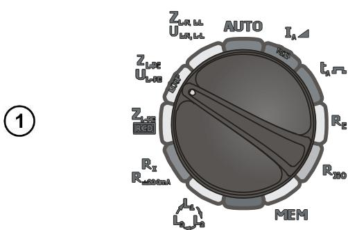
Установите поворотный переключатель в режим **Z<sub>L-PE</sub>/U<sub>L-PE</sub>**.
