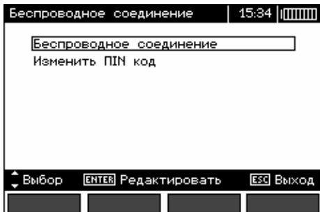
Нажмите ENTER для подключения к ПО «SonelReader», при подключенном адаптере OR-1 к ПК.
