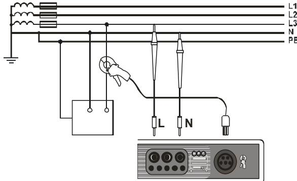
Подключите измеритель согласно схеме.
