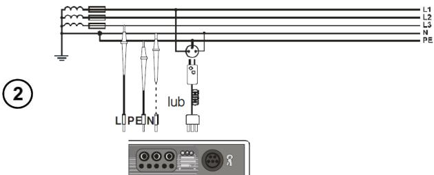
Подключите измеритель согласно схеме:
