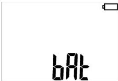
Аккумулятор полностью разряжен, все измерения блокируются.
