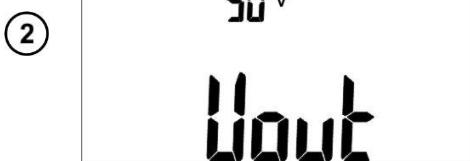
Клавишой **U<sub>n</sub>** установите измерительное напряжение 25В или 50В.
