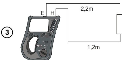
Подключите измеряемый объект к разъёмам **E** и **H**.
