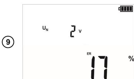
$R_{ER}$  – Дополнительная погрешность, зависящая от сопротивления измерительных зондов.
