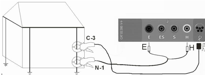
Подключить измерительные провода согласно рисунку.
