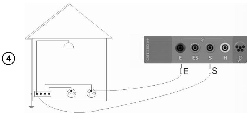
Подключите измерительные провода согласно рисунку.
