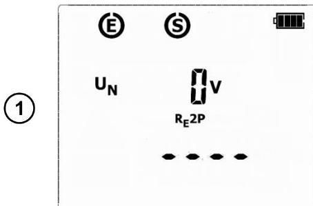
В режимах измерения **2Р**, **3Р**, **4Р**, **3Р+клещи**, **R<sub>cont</sub>**, **ρ**, до нажатия клавиши «СТАРТ», прибор контролирует напряжение на измерительных клеммах (между разъёмом Е и остальными разъёмами), а значение напряжения помехи отображается на дисплее.
