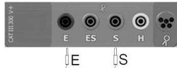
Подключить измерительные провода согласно рисунку.
