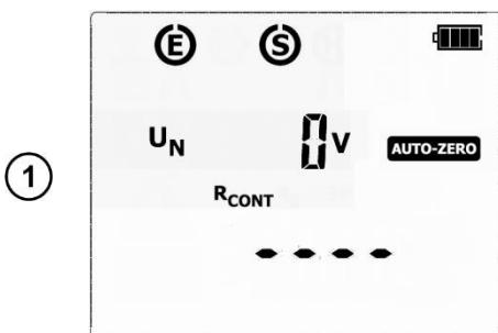
В режиме R<sub>cont</sub> используя клавишу **УСТ/ВЫБ** перейти к экрану автоматического обнуления сопротивления измерительных проводов **AUTO-ZERO**.
