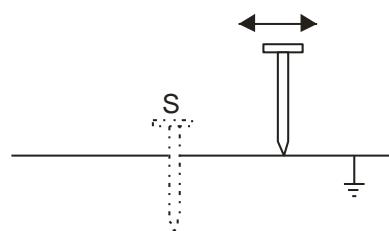
Если результаты измерения  $R_E$  отличаются друг от друга более чем на 3 %, то необходимо значительно увеличить расстояние от токового зонда до тестируемого заземления и повторить измерения.
