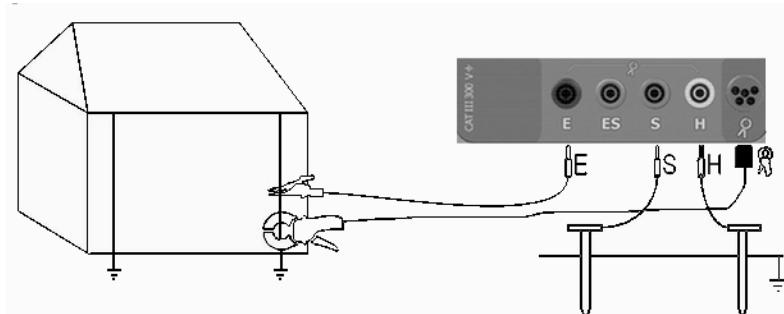
Подключить измерительные провода согласно рисунку.
