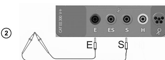
Подключить измерительные провода согласно рисунку.
