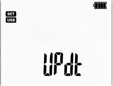
Клавишами **←** и **→** перейдите к следующему экрану настройки функции **UPdt** для обновления программного обеспечения измерителя.
