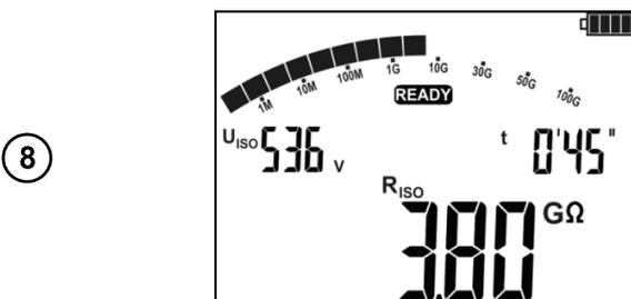
После окончания измерения сравните результат на дисплее с выставленным значением симулятора СК-1 согласно собранной схеме.
