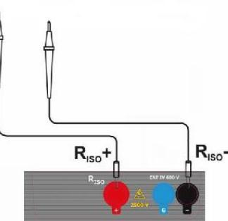
Подключите измерительные провода к разъёмам СК-1.
