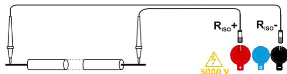
Подключите измерительные провода согласно рисунку.
