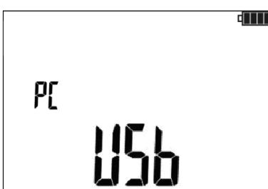
Подключите кабель от порта USB компьютера к разъёму USB измерителя. На дисплее прибора отобразится сообщение **USB**.
