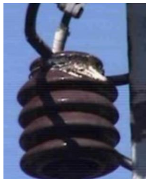
Рис. 9,10. Коронный разряд и его последствия
