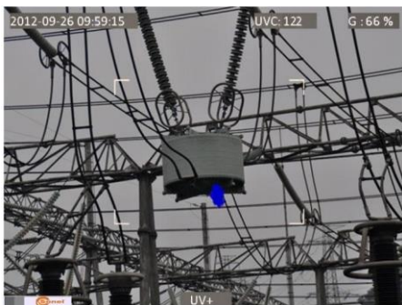
Рис. 5-8. Коронные разряды в реальных условиях электросетей
