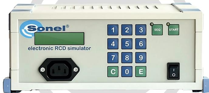
Калибратор ERS-2 обеспечивает имитацию работы устройств защитного отключения (УЗО) с заданным временем отключения. Необходимый номинал времени срабатывания УЗО задается пользователем с клавиатуры калибратора. Предусмотрен режим установки автоматической последовательности времени срабатывания.
