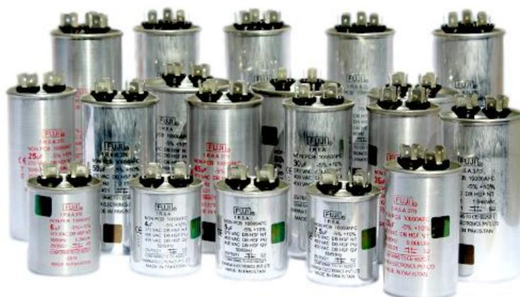
Конденсаторы предназначены для запуска асинхронных электродвигателей и создания фазосдвигающей цепи после выхода на рабочий режим. Применяются в асинхронных однофазных двигателях с двумя обмотками и в трёхфазных двигателях при работе в однофазной сети.
