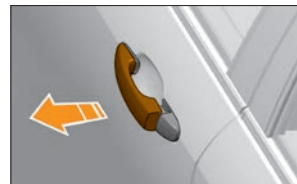
Рис. 1.6.1. Открытие боковых дверей снаружи
