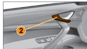
Рис. 1.6.2. Открытие боковых дверей изнутри
