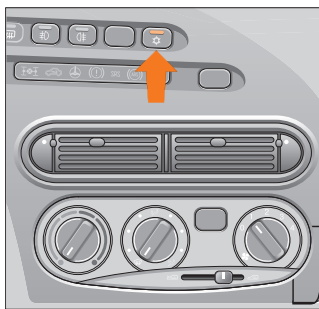
Рис. 60. Предохранение стёкол от запотевания и замерзания
