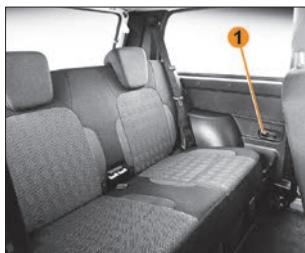
Рис. 4а. Местоположение ручки привода замка двери багажного отделения LADA Niva Legend
