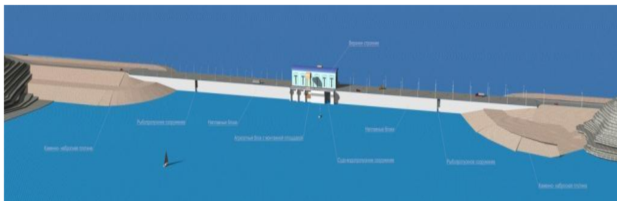
Компоновка сооружений опытно-промышленной Северной ПЭС
