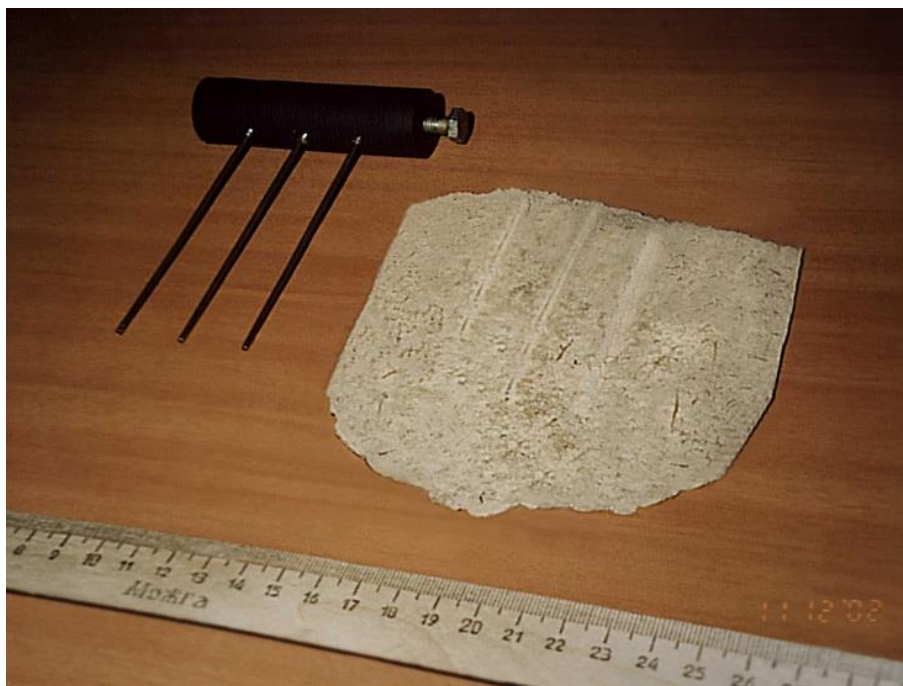
Рисунок 2.10. Вертикальные инъекционные тела, полученные в ходе лабораторных экспериментов: а – в монолите ИГЭ-1, б – ИГЭ-2; в – ИГЭ-3.
