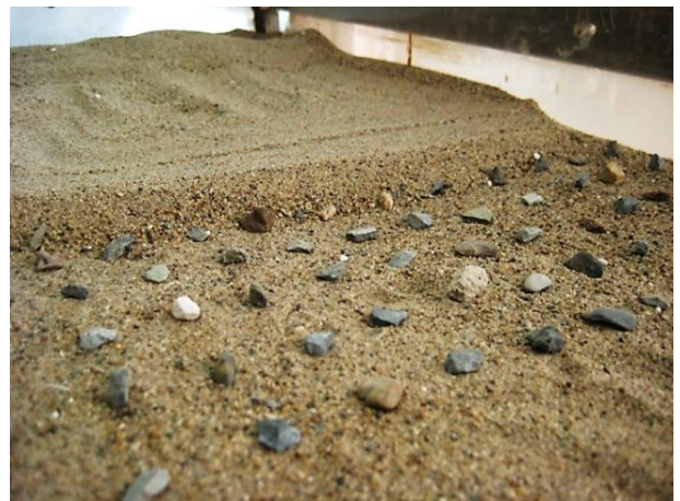
Рисунок 3.2. Слой щебня, уложенного по сетке с шагом \sim 2d \dots 3d
