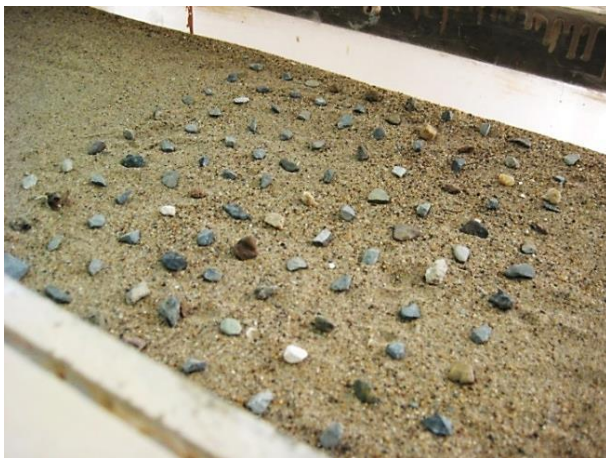
Рисунок 3.2. Слой щебня, уложенного по сетке с шагом \sim 2d \dots 3d
