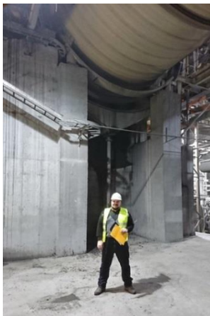
Рисунок 5.10. Возведение монолитного железобетонного фундамента под шаровую мельницу (а); шаровая мельница, введенная в эксплуатацию (б); регистрация параметров колебаний фундамента мельницы (в) [165].
