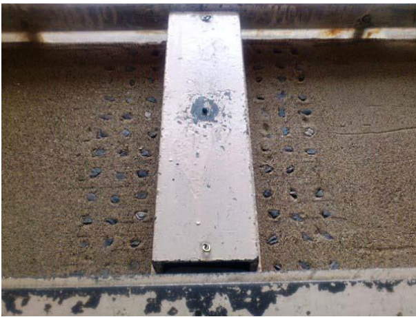
Рисунок 3.5. Щебень, уложенный по сетке с шагом \sim 2d \dots 3d :
