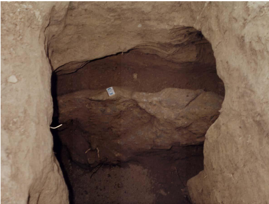
Рисунок 2.19. Вертикальные инъекционные тела, сформированные на опытной площадке: а, б, в – в ходе 1, 2 и 3-го эксперимента; г – габаритные размеры инъекционных тел.
