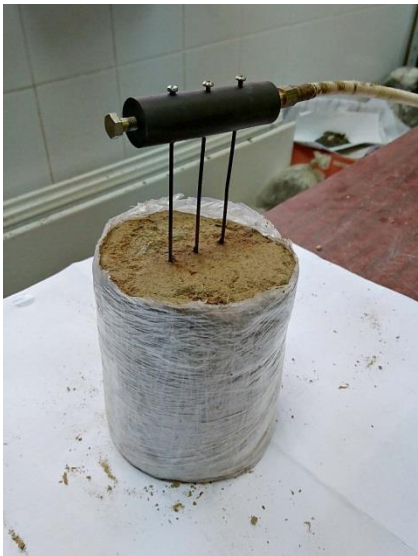
Рисунок 2.7. Погружение группы из трех инжекторов, расположенных вдоль прямой линии, в монолит ИГЭ-1 (а), ИГЭ-2 (б) и ИГЭ-3 (в).
