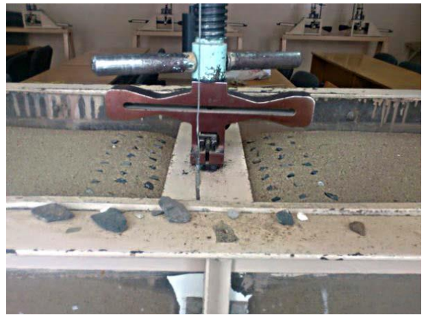
Рисунок 3.5. Щебень, уложенный по сетке с шагом \sim 2d \dots 3d :
