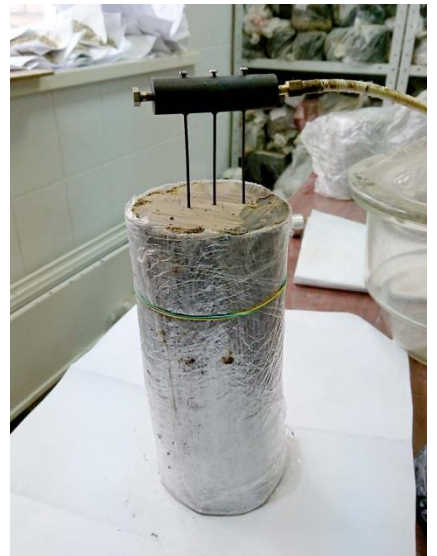
Рисунок 2.7. Погружение группы из трех инжекторов, расположенных вдоль прямой линии, в монолит ИГЭ-1 (а), ИГЭ-2 (б) и ИГЭ-3 (в).
