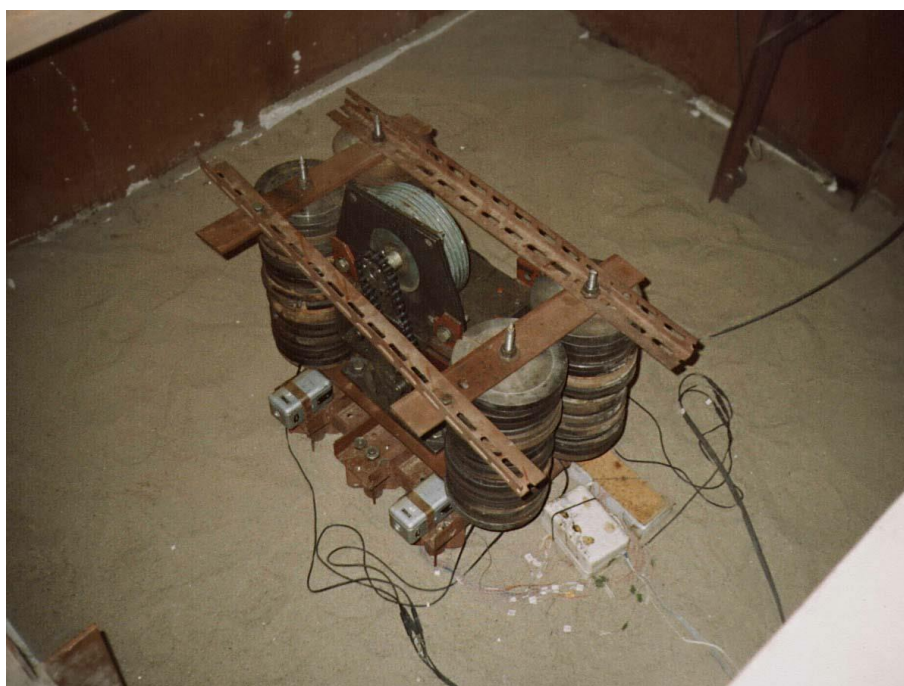
Рисунок 3.30. Модель свайного фундамента в большом грунтовом лотке с установленным 2-вальным вибратором направленного действия.
