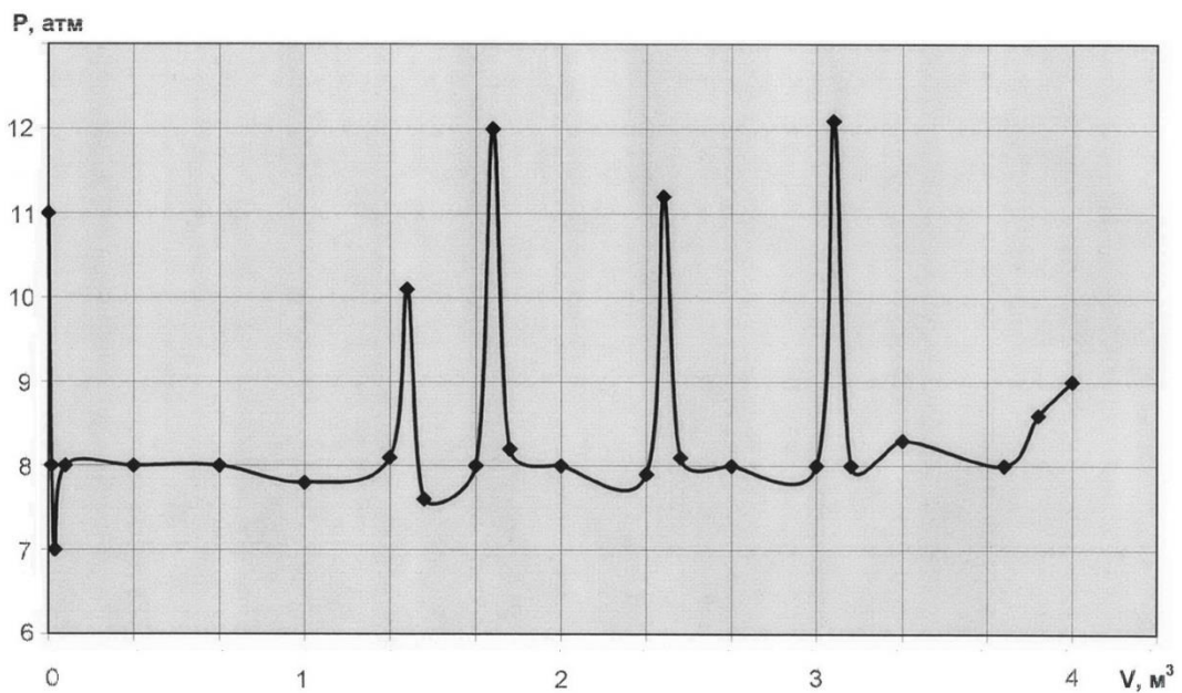
Рисунок 10. Кратковременное повышение давления при инъецировании на дополнительном горизонте.
