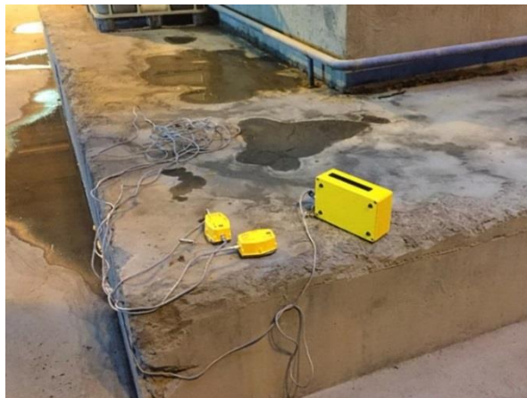
Рисунок 5.10. Возведение монолитного железобетонного фундамента под шаровую мельницу (а); шаровая мельница, введенная в эксплуатацию (б); регистрация параметров колебаний фундамента мельницы (в) [165].
