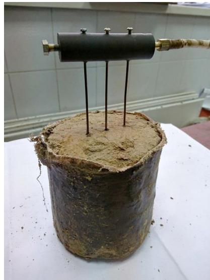
Рисунок 2.7. Погружение группы из трех инжекторов, расположенных вдоль прямой линии, в монолит ИГЭ-1 (а), ИГЭ-2 (б) и ИГЭ-3 (в).
