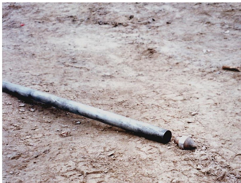
Рисунок 2.14. Иньектор с теряемым наконечником.
