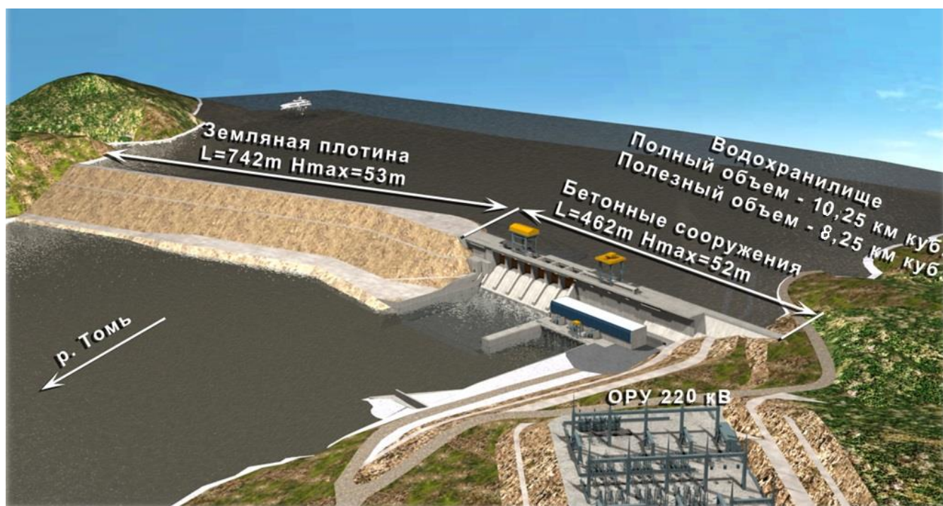
Рисунок 2 Модель размещения сооружений Крапивинской ГЭС в соответствии с вариантом ОТП 2021
