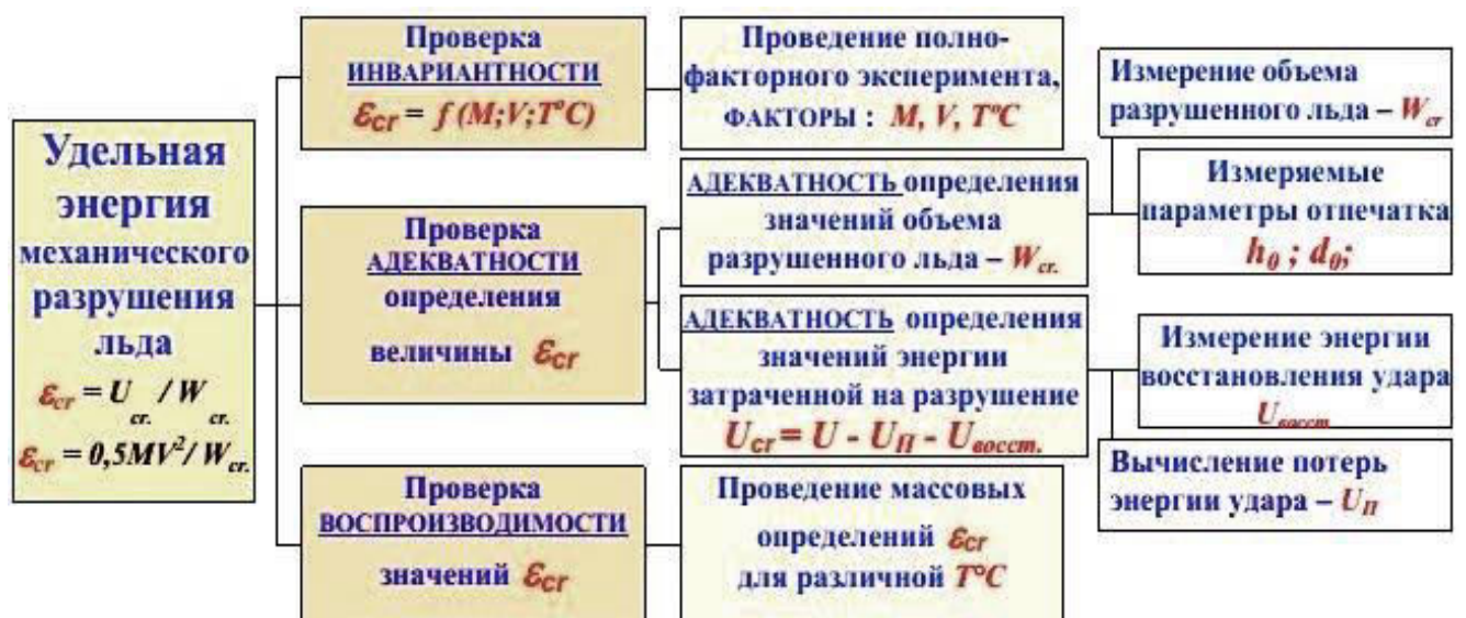
Рисунок 4.1.2 Блок-схема исследования некоторых критериев соответствия экспериментальных значений величины \epsilon^* её теоретическому описанию в математической модели разрушения льда
