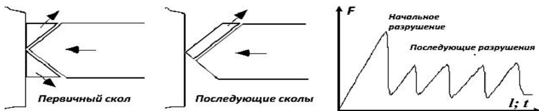
Рисунок 2.2.26 Схема очередности разрушения кромки ледового поля путем скалывания клиновидных блоков льда и соотношения пиков ледовой нагрузки в начале процесса и далее по Croasdale с соавторами [10]
