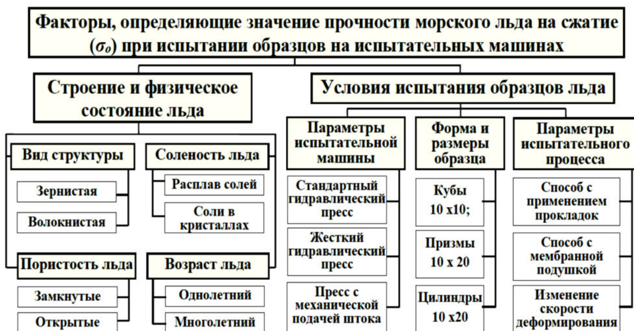
Рисунок 1.4.2 Таблица факторов, значимых для реальной прочности льда
