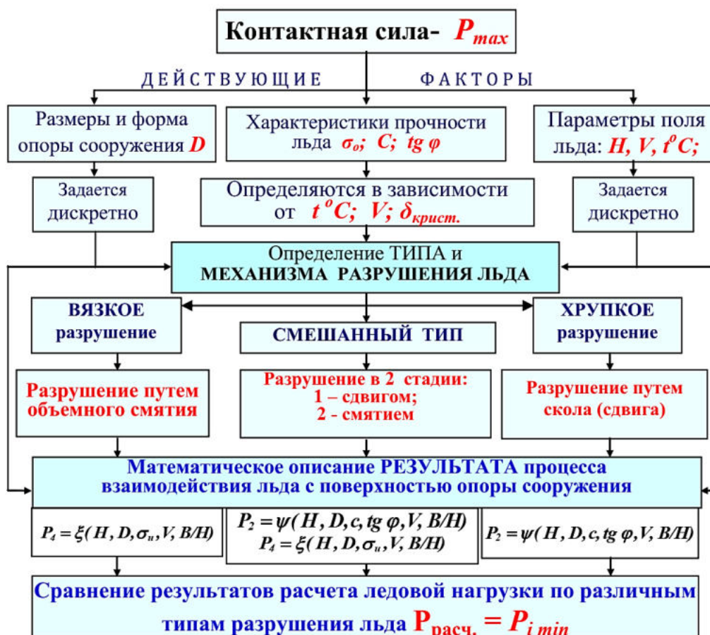
Рисунок 6.2.6 Схемы моделей разрушения льда, отдельно учитывающих типы механизмов разрушения льда на кромке ЛП: путем смятия льда на контакте ЛП с МЛС (учитывается в нормативном документе); путем сдвигов блоков у свободных поверхностей ЛП; комбинации двух типов механизмов разрушения по [125]
