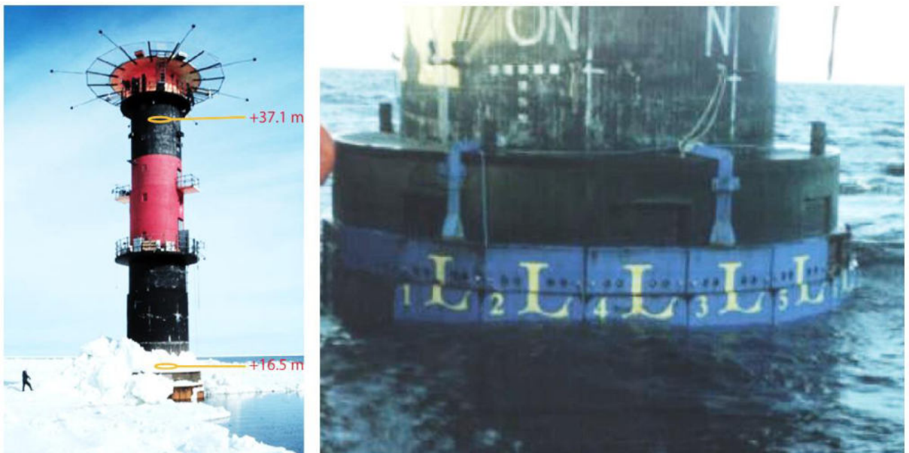
Рисунок 2.3.3 Размещение навесных измерительных тензометрических панелей на кессоне маяка Norströmsgrund
