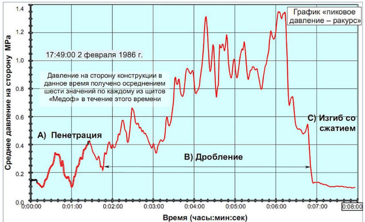
Рисунок 2.3.7 Типичный случай разрушения (дробления со сколом) ледяного поля на платформе Моликпак ( по Вершинину и др. [145])
