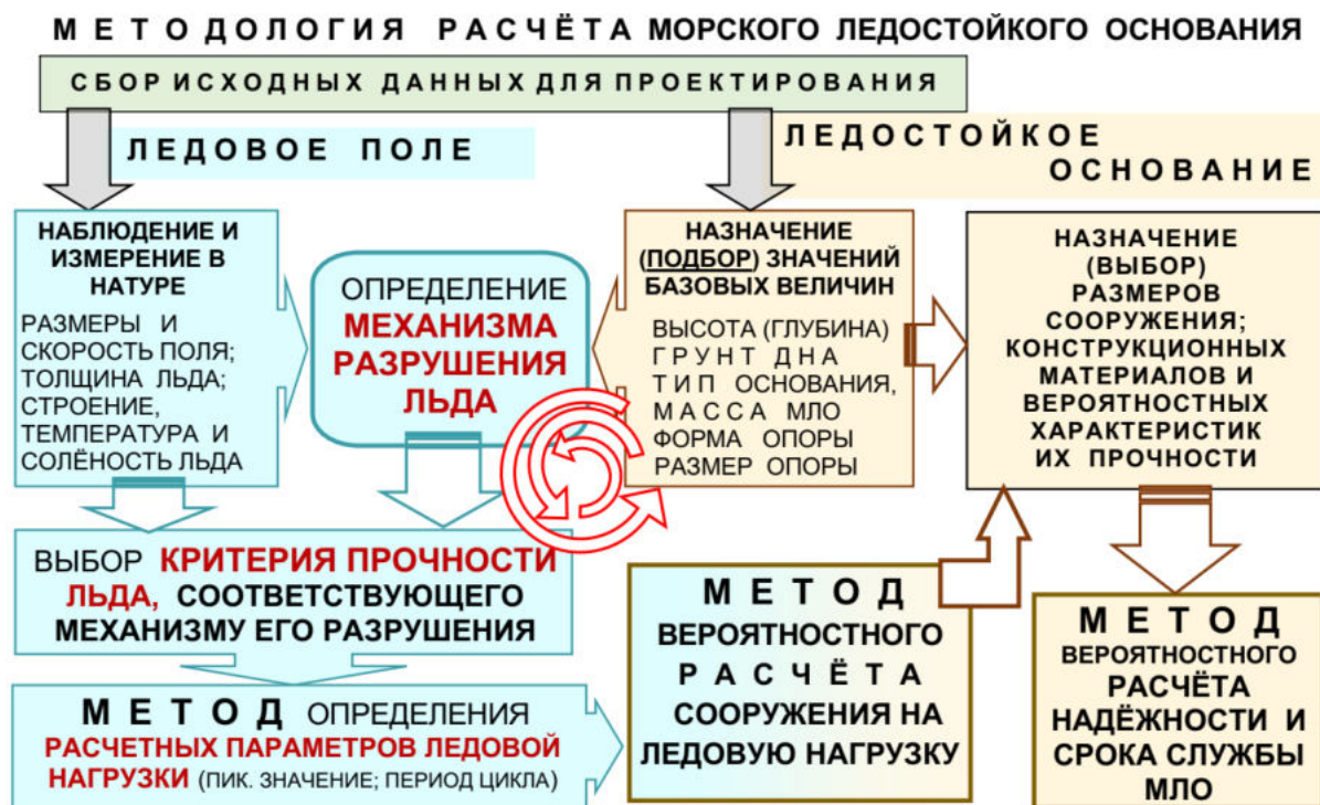
Рисунок 3.1.4 Место «процессора» - механизма разрушения льда, и его роль в определении ледовой нагрузки на МЛО в системе элементов проектируемой методологии обеспечения надежности и долговечности морского ледостойкого основания (МЛО)
