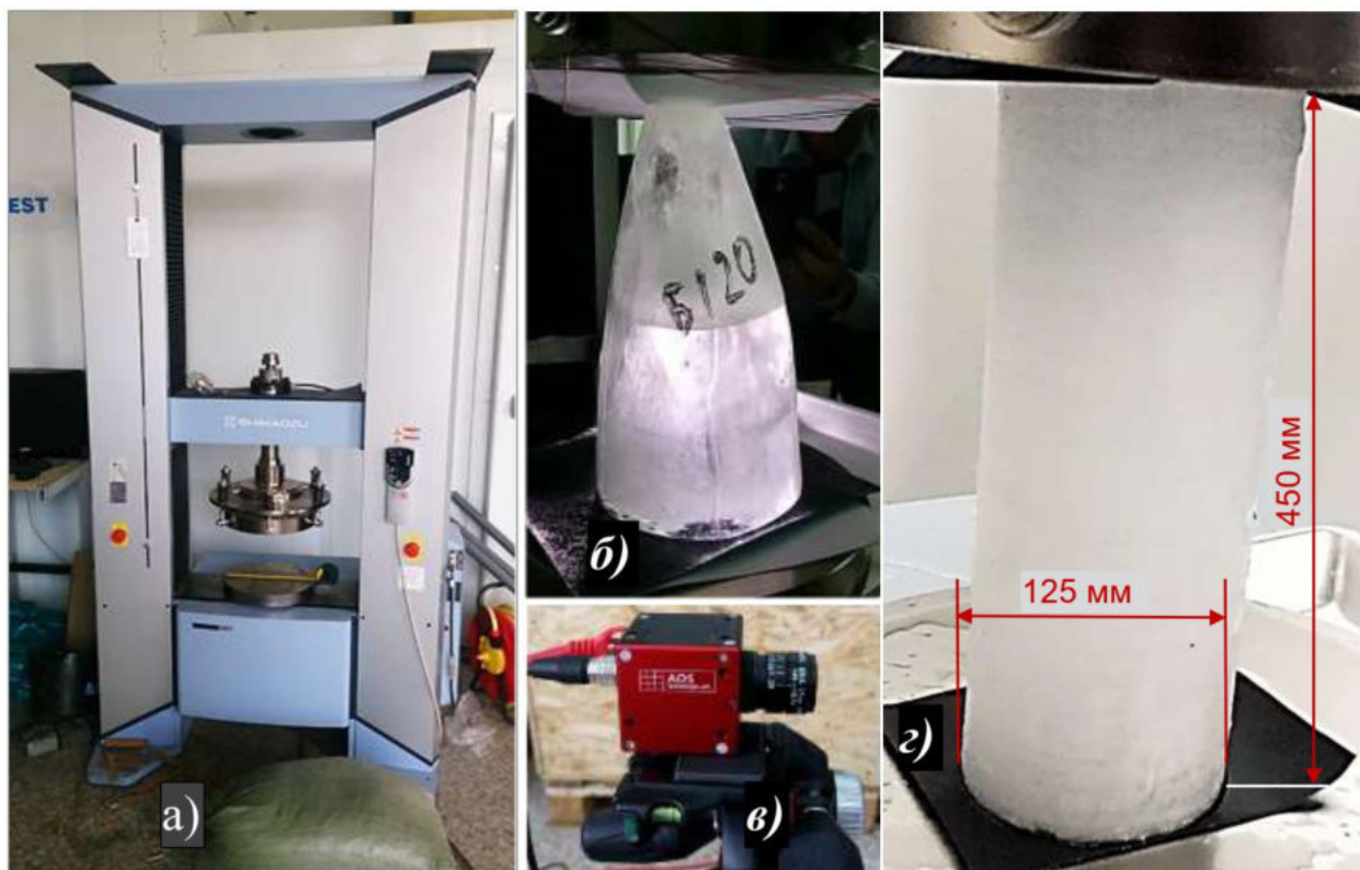
Рисунок 6.3.4 Испытательная машина (а), регистрирующая процесс скоростная камера (г) и примеры образцов пресного (б) и морского (з) льда
