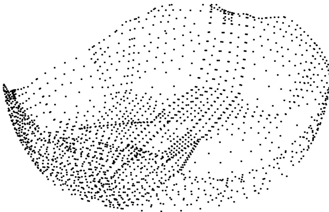
Рисунок 2.13 – Элементы «пружина-демпфер», присоединенные к граничным узлам основания. К каждому узлу границы (точка на рисунке) присоединено 3 элемента «пружина-демпфер», действующих по трем направлениям в пространстве
