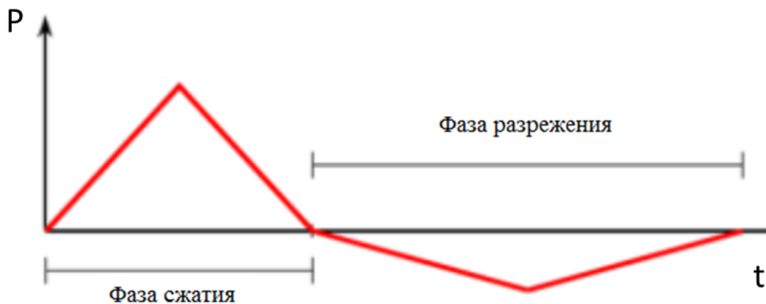
Рисунок 3.23 – Форма зависимости давления P от времени t для задания воздействия взрывной волны на верхнюю плиту ОГТ [179]
