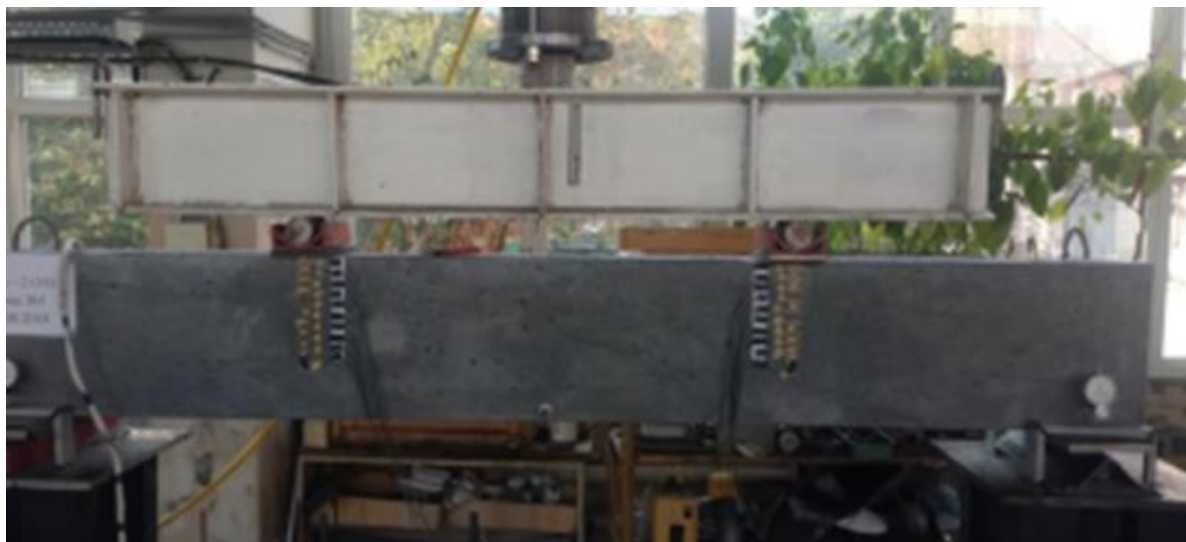
Рисунок. 3.9 – Оснащённая и готовая к испытаниям на четырехточечный изгиб железобетонная балка [145]
