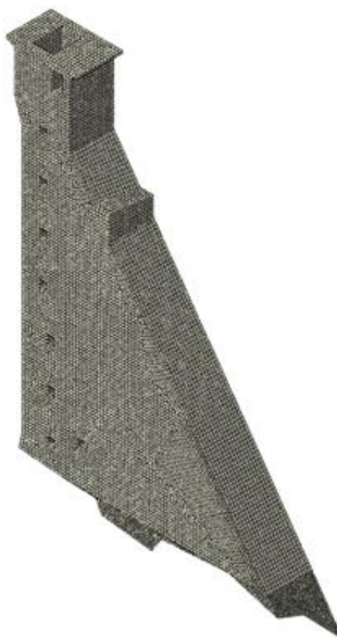
Рисунок 4.22 – Фрагмент конечно-элементной модели 1, 16 секция плотины Бурейской ГЭС
