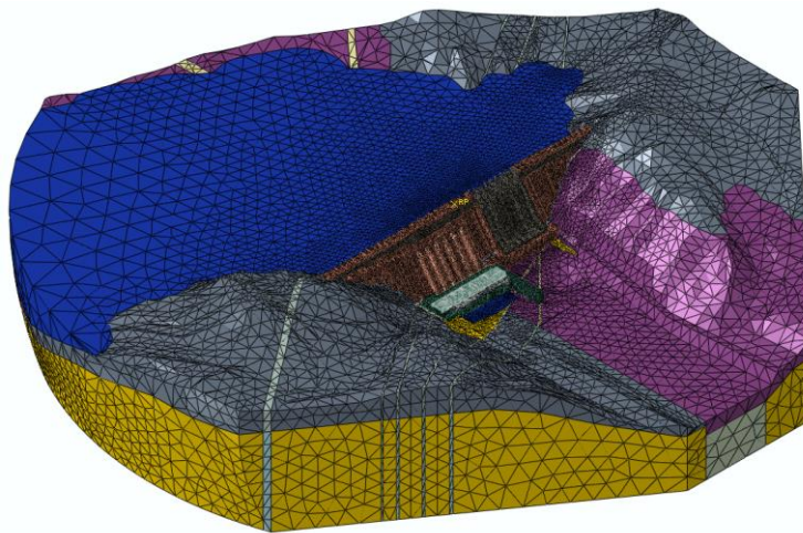
Рисунок 4.1 – Трехмерная конечно-элементная модель системы «основные бетонные сооружения Бурейской ГЭС – скальное основание – водная среда» [45]
