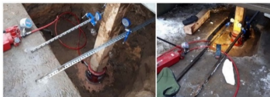
Рисунок 6 – Испытания грунтов штампом №1, 2 на контрольном участке на глубине 0,4 и 1,2 м соответственно
