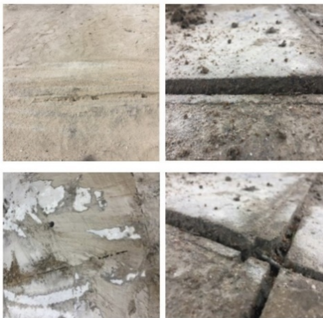
Рисунок 3 – Результаты подъема по разным краям плиты опытного фундамента
