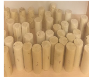
Рисунок 12 – Полученные образцы смолы различной плотности
