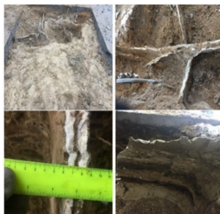
Рисунок 5 – Распространение затвердевшей смолы в массиве закреплённого грунта
