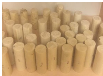
Рисунок 3.5 – Подготовленные образцы смолы различной плотности
