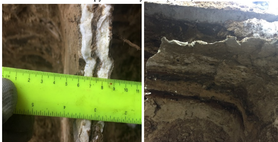
Рисунок 2.377 – Различные формы распространения затвердевшей смолы в массиве закреплённого грунта по глубине на глубине (1,1 m)
