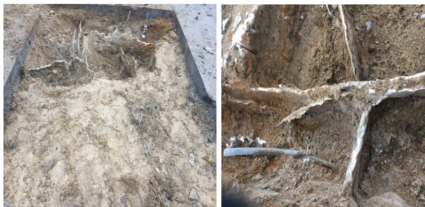
Рисунок 2.36 – Различные формы распространения смолы в массиве закреплённого грунта на глубине (0,4 m)
