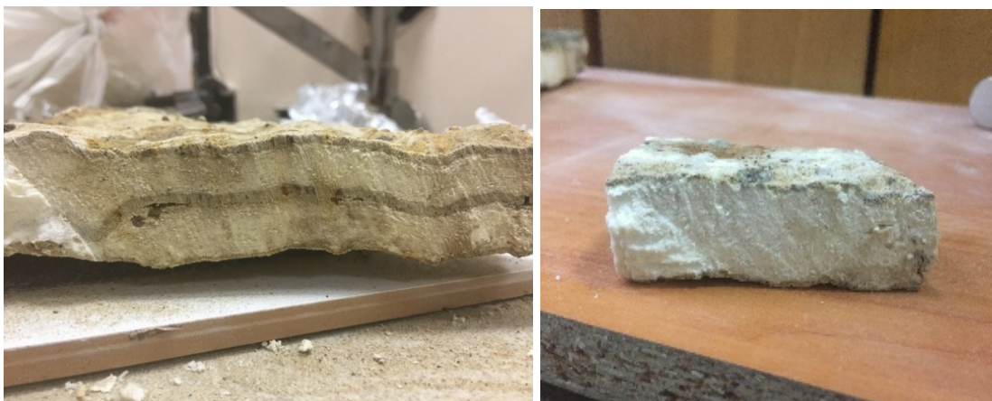
Рисунок 3.1 – Образцы смолы извлеченные из инъецированного участка после процесса нагнетания в полевых условиях
