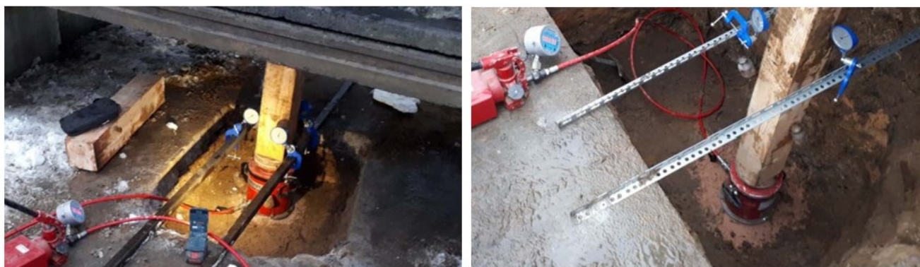
Рисунок 2.39 – Испытания грунтов штампом №1 и №2 на контрольном участке на глубине 0,4 и 1,1 м соответственно
