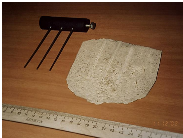
Рисунок 2. Вертикальное (а) и горизонтальное (б) инъекционное тело, сформированное в ходе лабораторных экспериментов.
