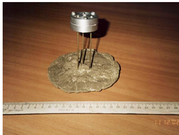
Рисунок 2. Вертикальное (а) и горизонтальное (б) инъекционное тело, сформированное в ходе лабораторных экспериментов.
