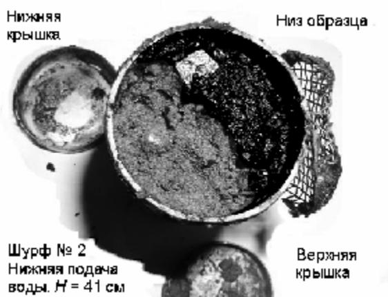
Рис. 1. Вид образца песчаного грунта по окончании опыта
