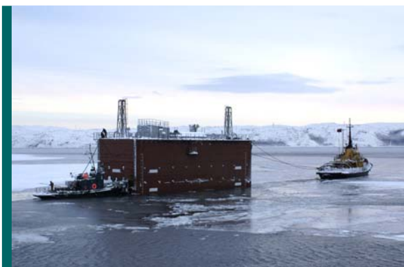
Буксировка наплавного энергоблока
