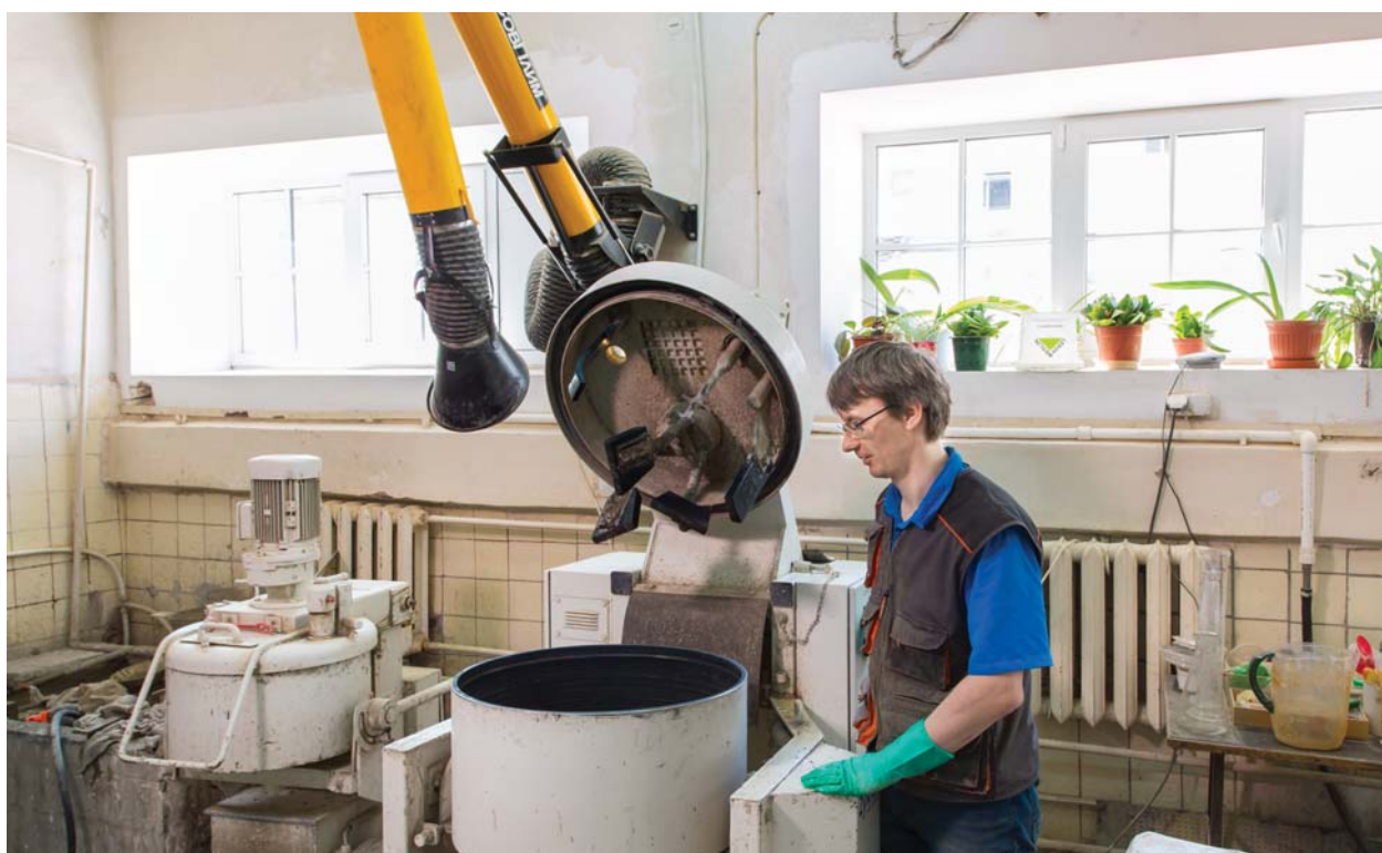
Приготовление самоуплотняющейся бетонной смеси в лабораторной бетономешалке
