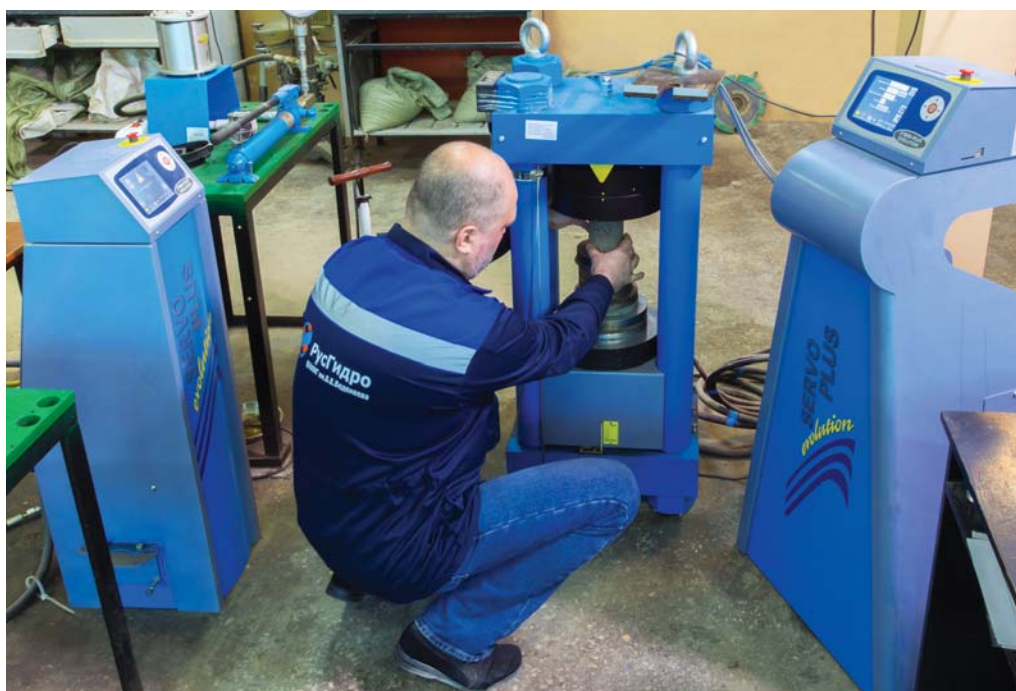
Определение прочностных и деформационных характеристик грунта
