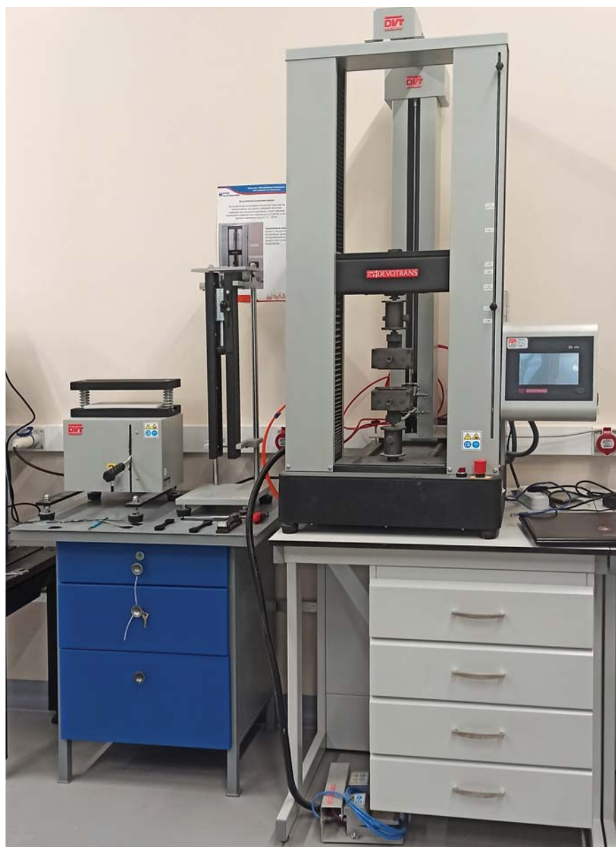
Лабораторная установка для комплексного исследования геосинтетических материалов в обновлённой лаборатории фильтрационных исследований им. акад. Н.Н. Павловского
