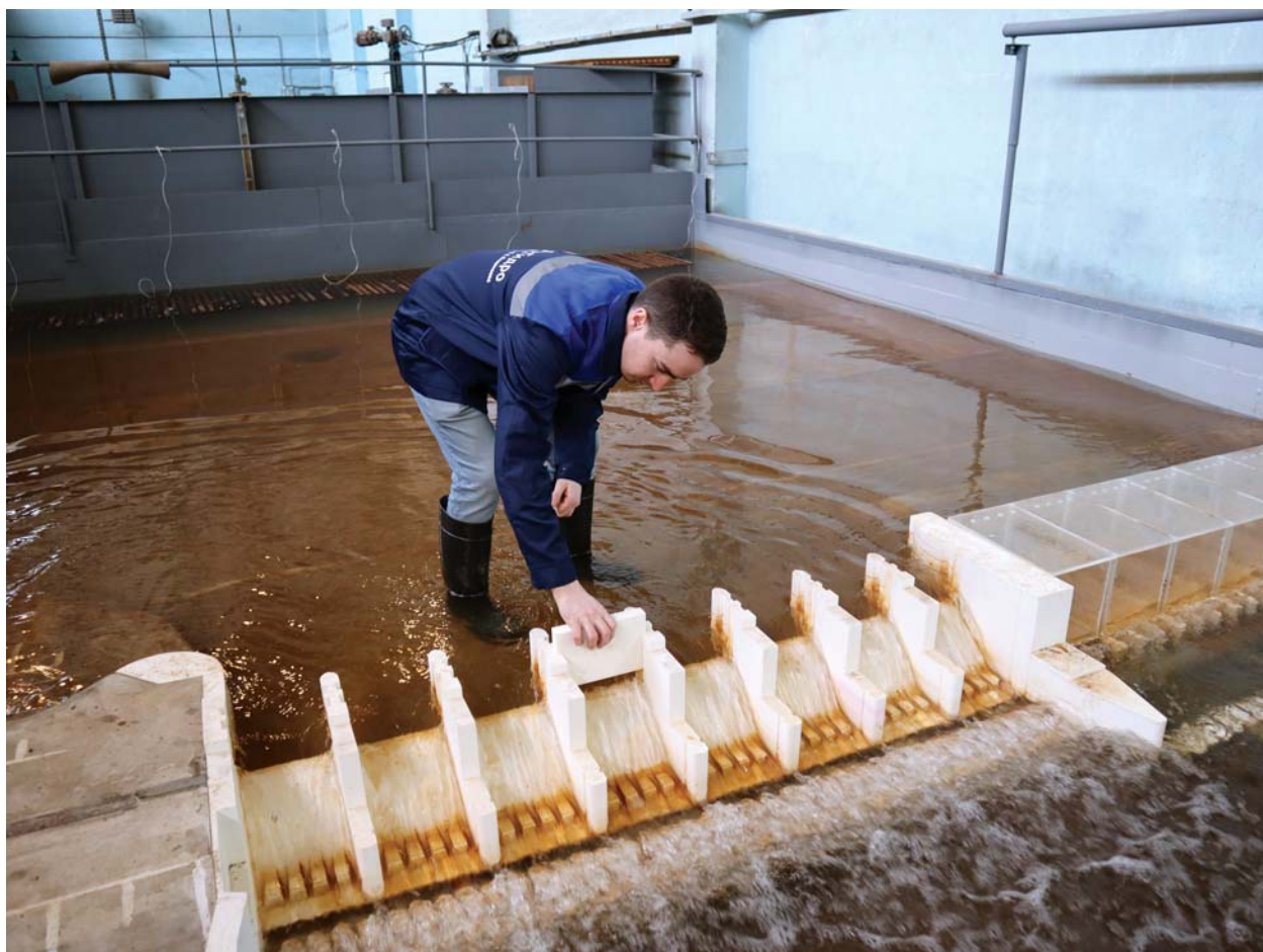
Выполнение измерений на модели Новосибирской ГЭС
