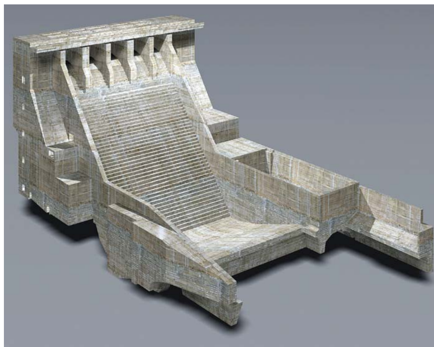
Трёхмерная геометрическая модель водосброса Богучанской ГЭС
