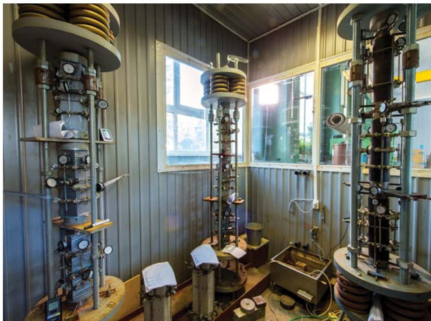
Лабораторное помещение с заданным микроклиматом для измерения деформаций бетона при долговременном воздействии нагрузок, температуры и влажности
