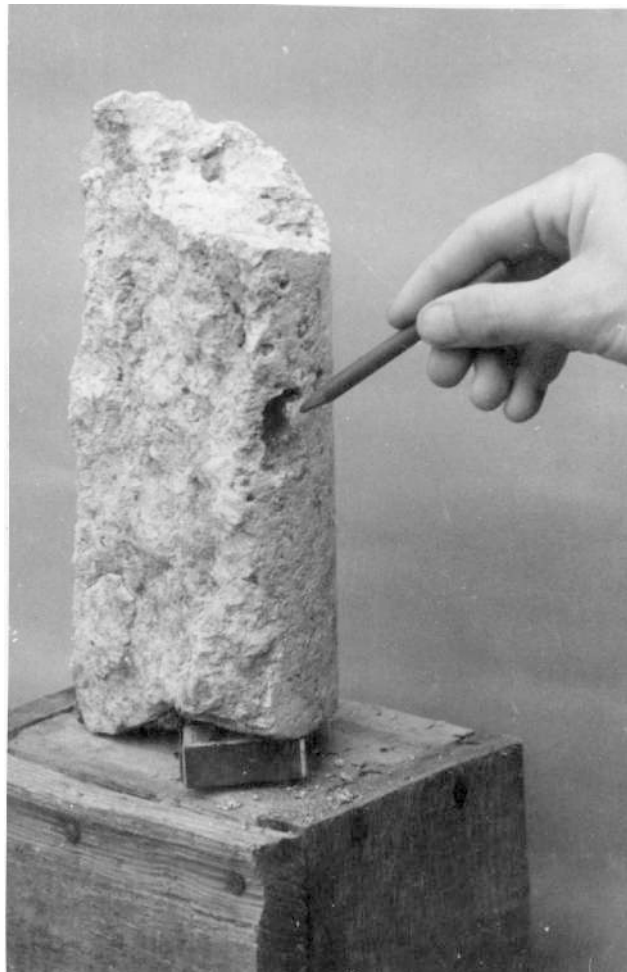
Грунты основания гидростанции. Известняк серый, твёрдый.
