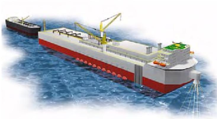
Рис. 3. Плавающая система для добычи, хранения и отгрузки (FPSO)
