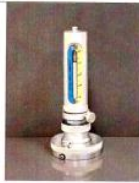
2. Прибор VM-6 для определения водоотдачи и толщины глинистой корки
