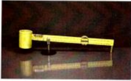
1. Рычажные весы для определения плотности глинистого раствора
