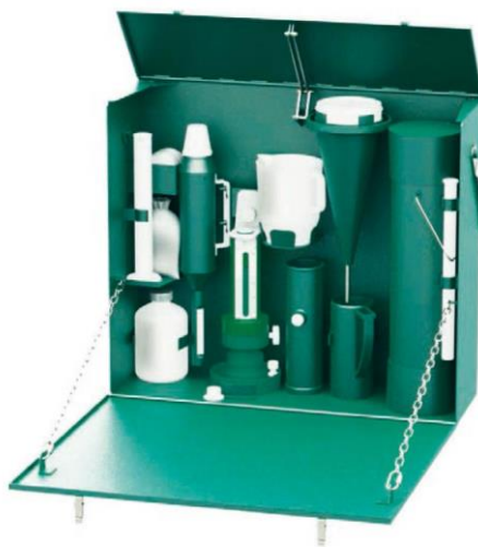
Рисунок 1.1 - Состав лаборатории глинистых растворов ЛГР-3
