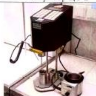
6. Вискозиметр ротационный OFITE 800 для для определения статического напряжения сдвига
