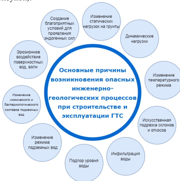
Причины возникновения опасных инженерно-геологических процессов
