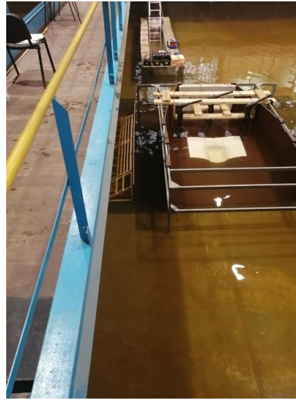
Рис. 16. Проведение теста со стенкой ГТС увеличенной длины до 71,8 м (в пересчете на натурные данные)
