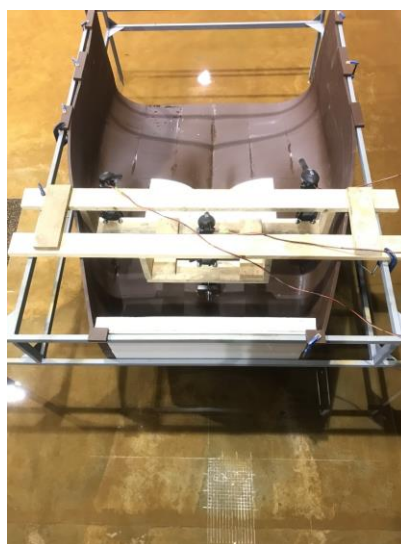
Рис. 5. Модель кормы танкера с установленными лодочными моторами, размещенная на передвигаемой подставке с ножками регулируемой высоты
