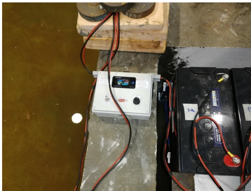
Рис. 2. Устройство для плавной регулировки подачи мощности на электродвигатель лодочного мотора
