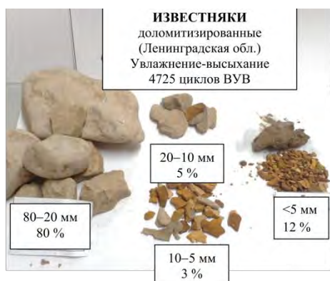
Рис. 9. Гранулометрический состав горной массы доломитизированных известняков Ленинградской области после 4725 циклов увлажнения-высыхания (с исходными фракциями при 0 циклов – 20–80 мм).
