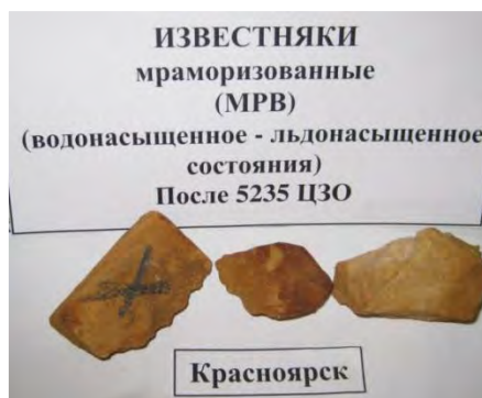
Рис. 7. Дезинтеграция известняка мраморизованного (Красноярская ГЭС) после 5235 ЦЗО; водонасыщенное и льдонасыщенное состояния (МРВ)
