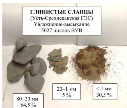
Рис. 10. Гранулометрический состав горной массы метаморфизованных глинистых сланцев участка Усть-Среднеканской ГЭС на р. Колыме после 5027 циклов увлажнения-высыхания (при исходном гранулометрическом составе 20–80 мм)
