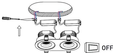
Подключите провода сети питания к драйверу светильника, затем уберите драйвер в запотолочное пространство, отогните вверх пружинные ушки светильника и установите его в отверстие.
