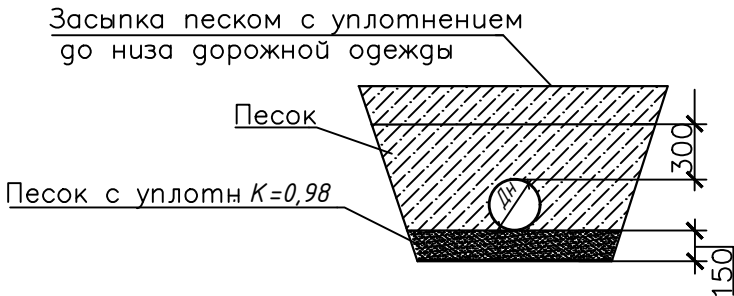
Схема укладки полиэтиленовых труб в пределах выполнения благоустройства
