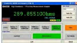
Программные средства «виртуальная панель управления», поставляемые вместе с адаптером, создают дружелюбный интерфейс пользователя с такими функциями, как обнуление, фильтрация и автоматический выбор диапазона. Под управлением программных средств ProCal EA008 совместим с автоматизированными процедурами, позволяющими проводить полную калибровку на уровне токов силой пА и высоких значений сопротивления.
