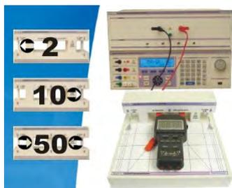
Сконструированная для калибровки обычных и основанных на эффекте Холла токовых клещей переменного и постоянного тока, комбинированная токовая катушка предлагает владельцу ряд уникальных возможностей, объединенных в прочном корпусе с нанесенной на него центровочной таблицей.
