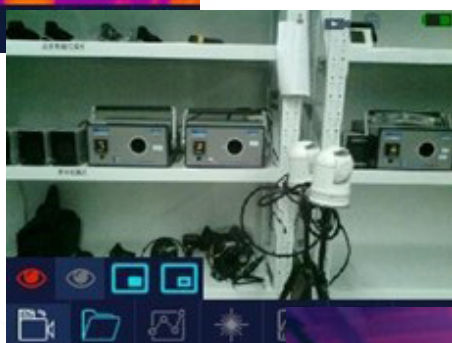
MIF – инфракрасное изображение наложенное на изображение с обзорной камеры
