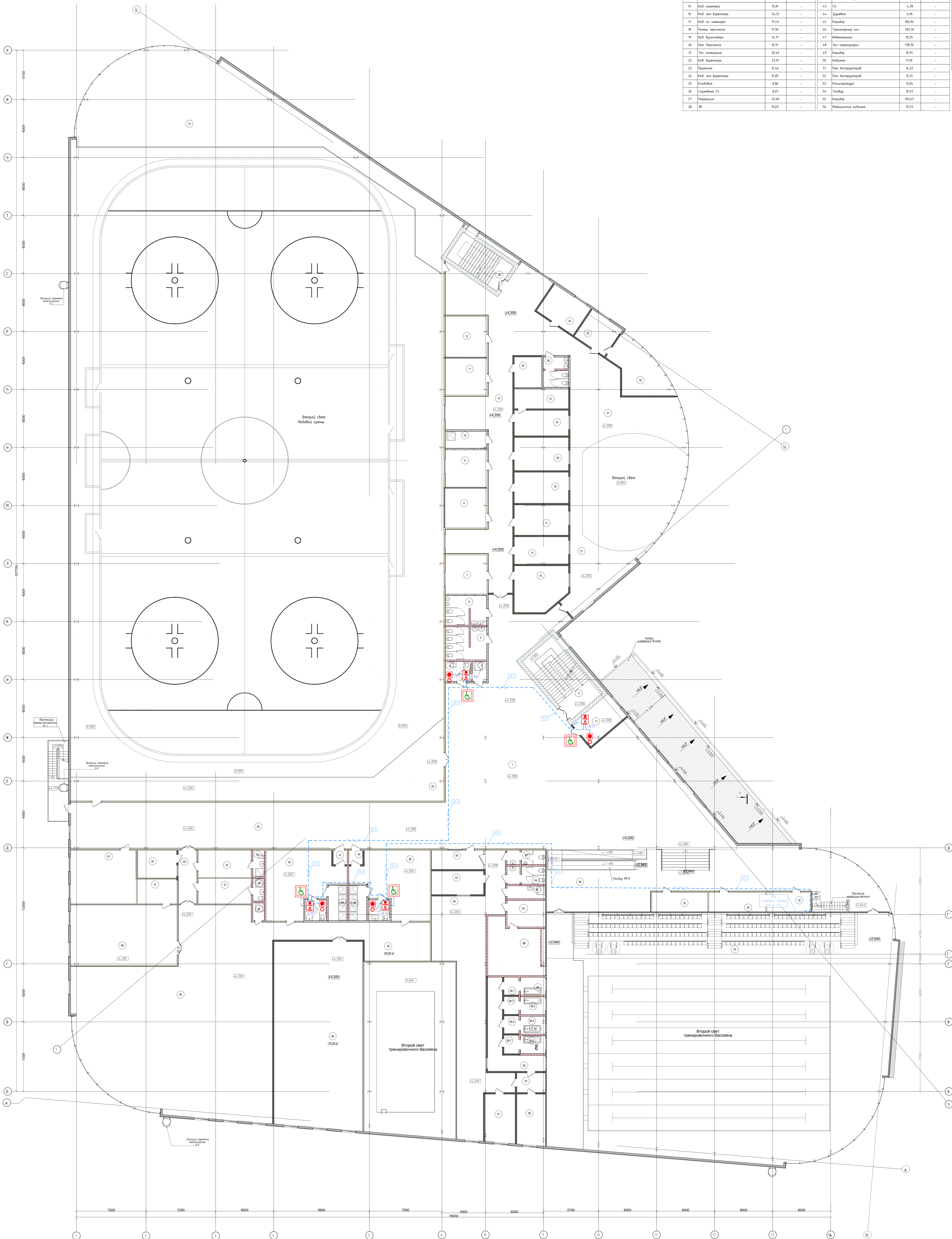
План расположения оборудования и прокладки кабелей системы беспроводной связи с оборудованием для маломобильных групп населения. Второй этаж
