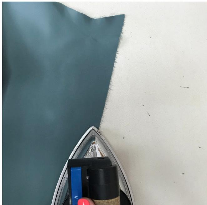
Перед дублированием основных деталей изделия рекомендуем проверить и продублировать дублерином и/или клеевой кромкой отдельный отрез основного материала. А также проверить настройки утюга: температуру, пар (возможно ли дублирование исходного материала с паром) и время выдержки, которое потребуется на приклеивание клеевого материала к основному. Продублировать полностью детали края:
