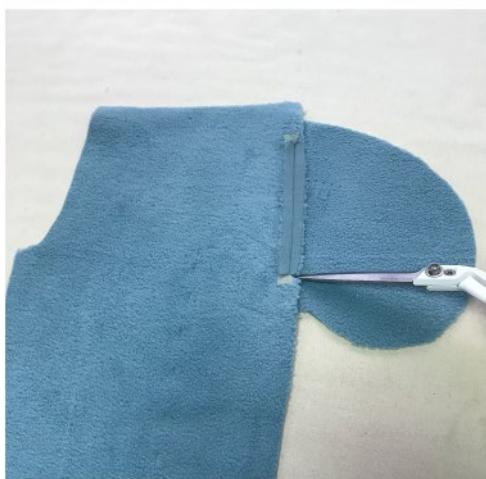
Рассечь припуск бокового шва и мешковины (два слоя) кармана в верхней и нижней точке входа в карман на глубину 8 мм.
