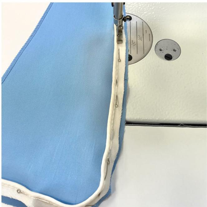
Притачать кант ко всем деталям на швейной машинке при помощи однорожковой лапки на расстоянии 1 см от среза, в начале и в конце строчки поставить закрепки.
