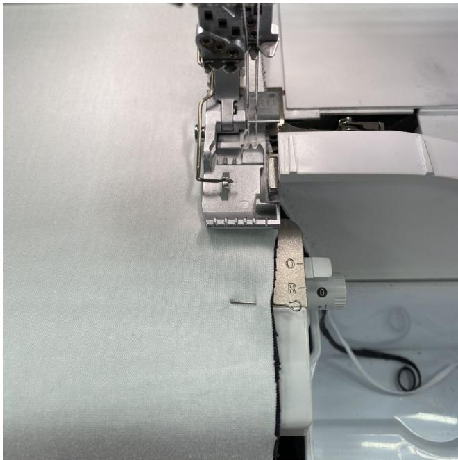
Притачать на оверлоке, проложив стачивающе-обметочную строчку со стороны детали спинки.
