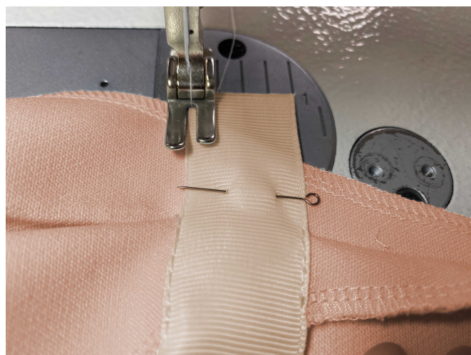
12. Притачать деталь усилителя на швейной машинке в два этапа: к припуску с одной стороны до шва и к припуску с другой стороны до шва. Выполнить закрепки в начале и в конце строчки.
