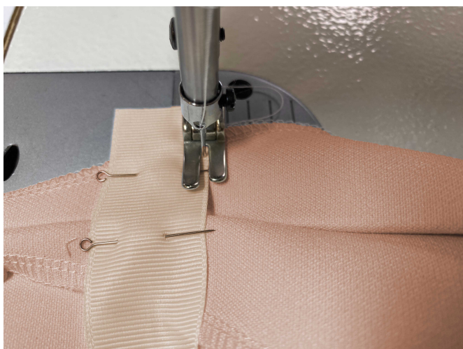
12. Притачать деталь усилителя на швейной машинке в два этапа: к припуску с одной стороны до шва и к припуску с другой стороны до шва. Выполнить закрепки в начале и в конце строчки.
