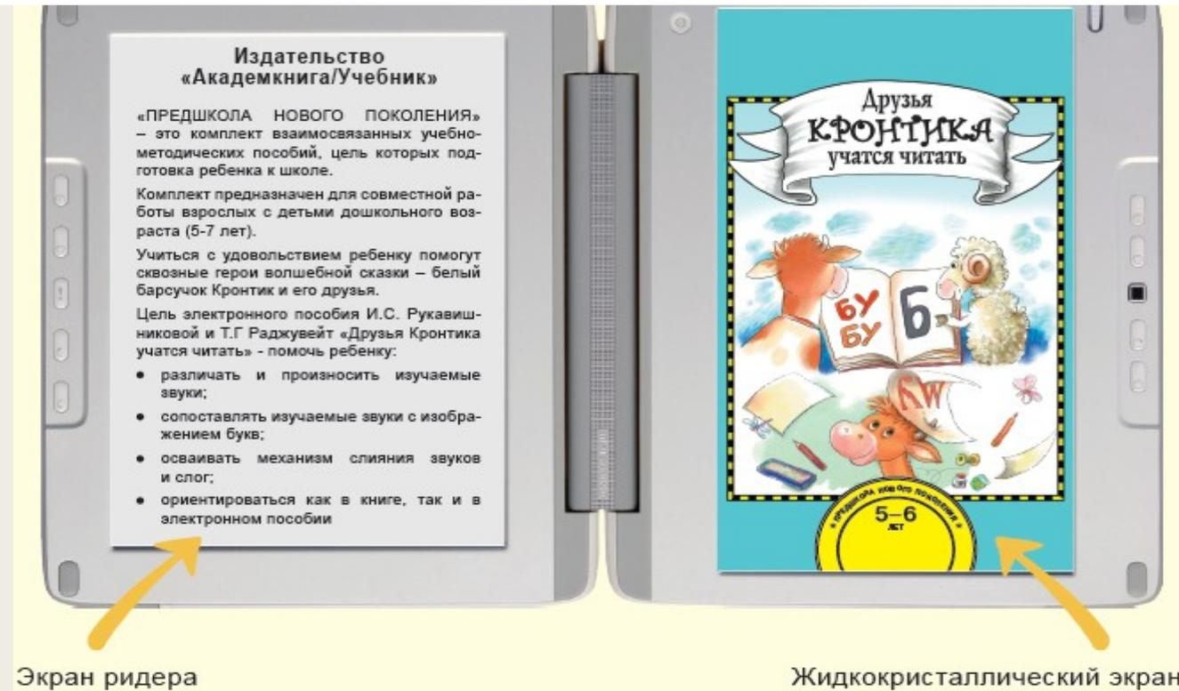
**Экран ридера создан по технологии электронных чернил и работает в отраженном свете; безопасен для зрения**
