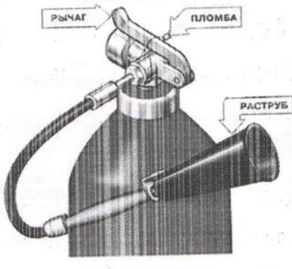
ПРИНЦИП ДЕЙСТВИЯ основан на вытеснении диоксида углерода избыточным давлением. При открывании запорно-пускового устройства СО<sub>2</sub> из сифонной трубки поступает к раструбу и из сжиженного состояния переходит в твердое (снегообразное). Температура резко (до -70 °С) понижается. Снегообразная масса, попадая на горящие вещества, изолирует его от кислорода.
