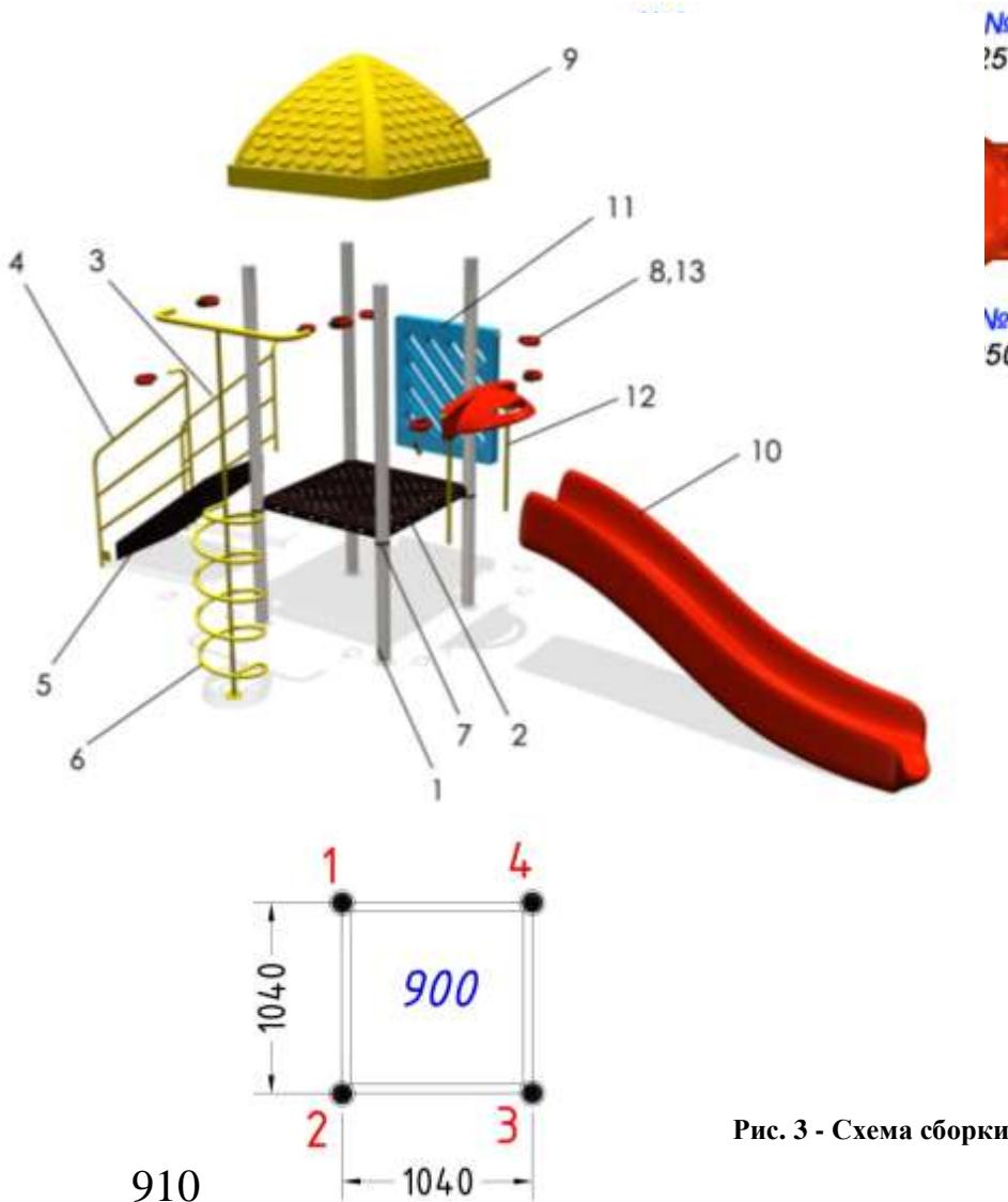
Рис. 3 - Схема сборки
