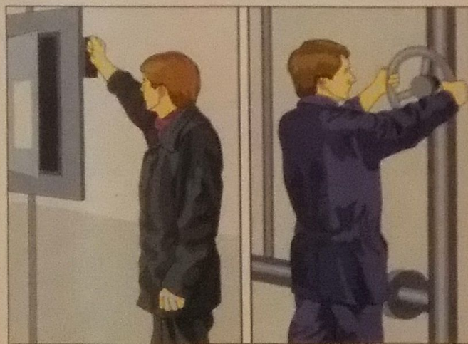
По команде руководителя остановить производство (оборудование) по схеме аварийного отключения. Отключить вентиляцию и электрооборудование. Перекрыть краны и задвижки на трубопроводах подачи газа, масла, агрессивных и горючих жидкостей. Открыть задвижки для их слива в аварийные ёмкости
