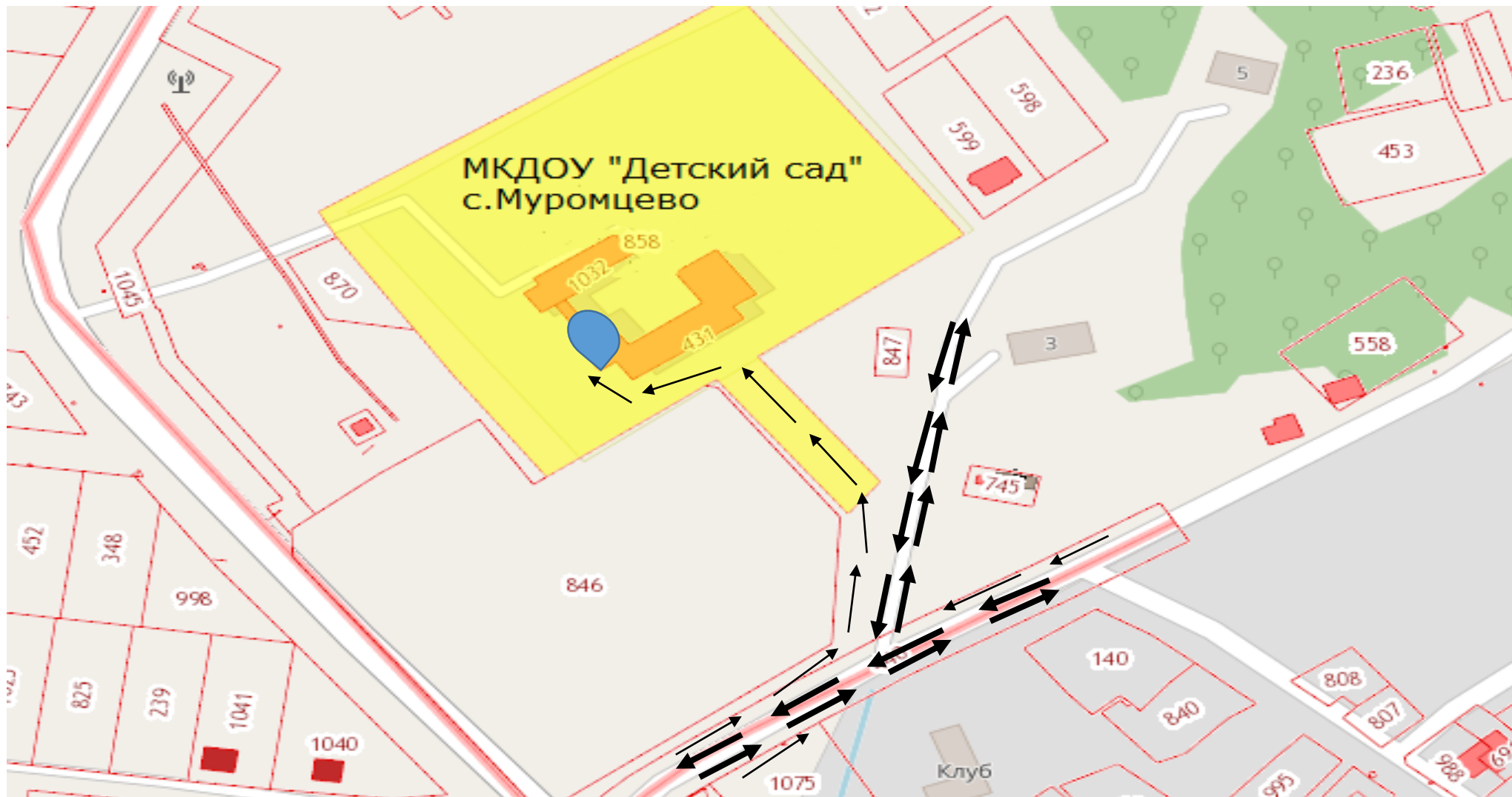
Схема №2. Организация дорожного движения в непосредственной близости от образовательной организации с размещением соответствующих технических средств организации дорожного движения, маршрутов движения детей
