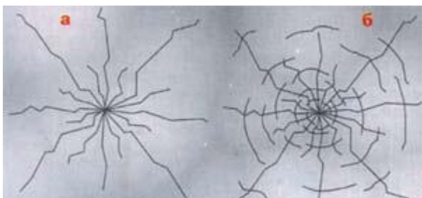
Рис.4. Типы растрескиваний льда под нагрузкой: а – радиальные трещины, не ведущие к провалу груза; б – радиальные трещины, сопровождаемые концентрическими разрушениями, ведут к быстрому провалу груза.
