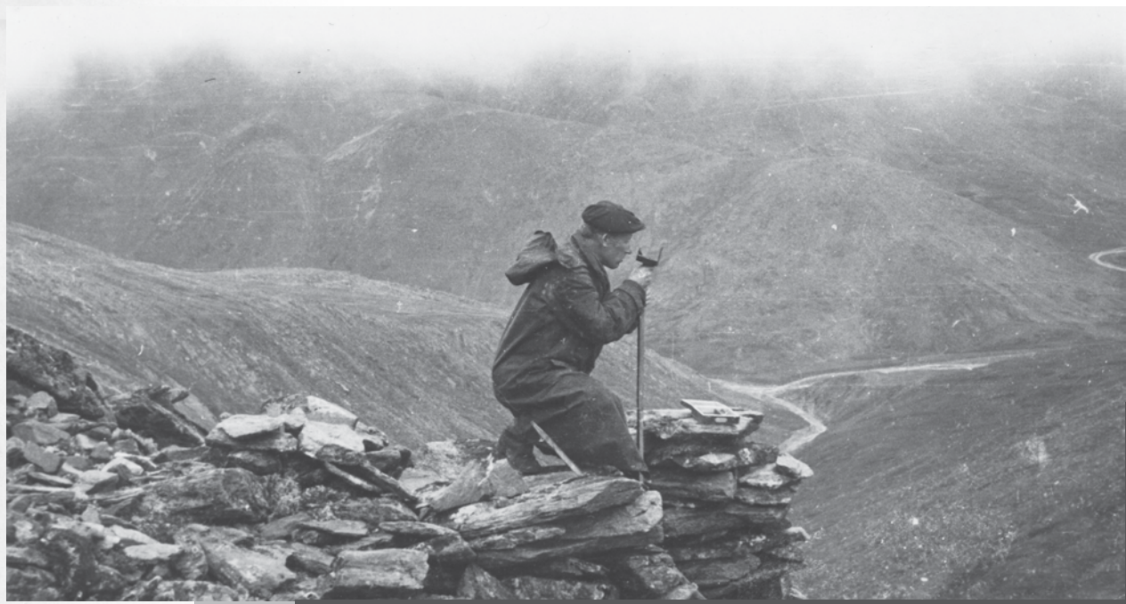
Геодезист проводит мензурную съёмку. Верхнеханмейское сурьмяное месторождение, 1954 год
